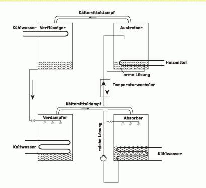
03 Die vier Komponenten bilden den Kältemittel- respektive Lösemittelkreis. Austreiber und Absorber treiben den Prozess an. Der Eintrag von Solarenergie erfolgt über den Austreiber. Absorber und Verflüssiger geben Wärme über ein Rückkühlwerk ab. Die nutzbare Kälte zur Kühlung wird im Verdampfer aus dem Prozess ausgekoppelt (Bild: Recknagel: Heizung- + Klimatechnik, München 2006)
