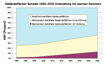
03 Relative Bedeutung der drei Stufen der Technisierung im Szenario «Entwicklung mit warmen Sommern» (Bild: Autoren)
