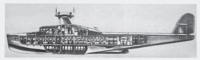
Abb. 1. Längsschnitt des Dornier-Flugschiffes "Do. X". - Masstab 1: 210. - Im Oberdeck vorn Führer- und Navigationsraum, dahinter Schaltraum und Funkraum.
