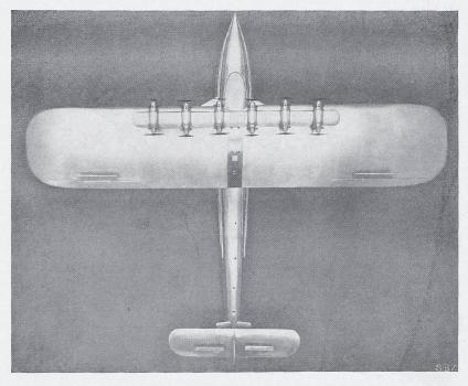
Abb. 6. Das Dornier-Flugschiff "Do. X\*, Draufsicht des Modells. — Masstab 1:400. Länge zwischen den Löten 40,05 m, Spannweite 48 m, Flügelbreite 9,5 m.
