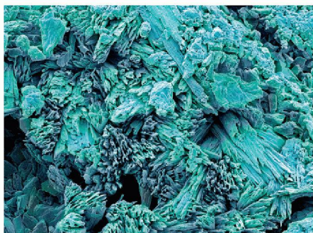
Kolorierte Aufnahme von Gipskristallen unter dem Raster-elektronenmikroskop (Bild: KEYSTONE / Science Photo Library / Steve Gschmeissner)
