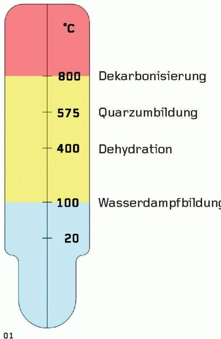
01 Temperaturniveau und Schädigungsmechanismen im Beton (Bilder: Versuchsstöllen Hagerbach AG)
