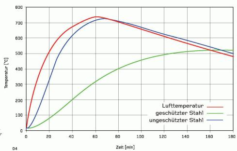
04 Temperaturen im Beispielbrandraum, in einem ungeschützten Verbundträger IPE 450 (mit aufliegender Betonplatte) sowie in einem mit 20 mm Fasersilikatplatten kastenförmig geschützten IPE 450 bei einer Brandbelastung von 500 MJ/m² (Grafik: Autoren)
