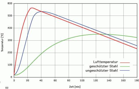
03 Temperaturen im Beispielbrandraum, in einem ungeschützten Verbundträger IPE 450 (mit aufliegender Betonplatte) sowie in einem mit 20 mm Fasersilikatputz profilifolgend geschützten IPE 450 bei einer Brandbelastung von 200 MJ/m²(Grafik: Autoren)
