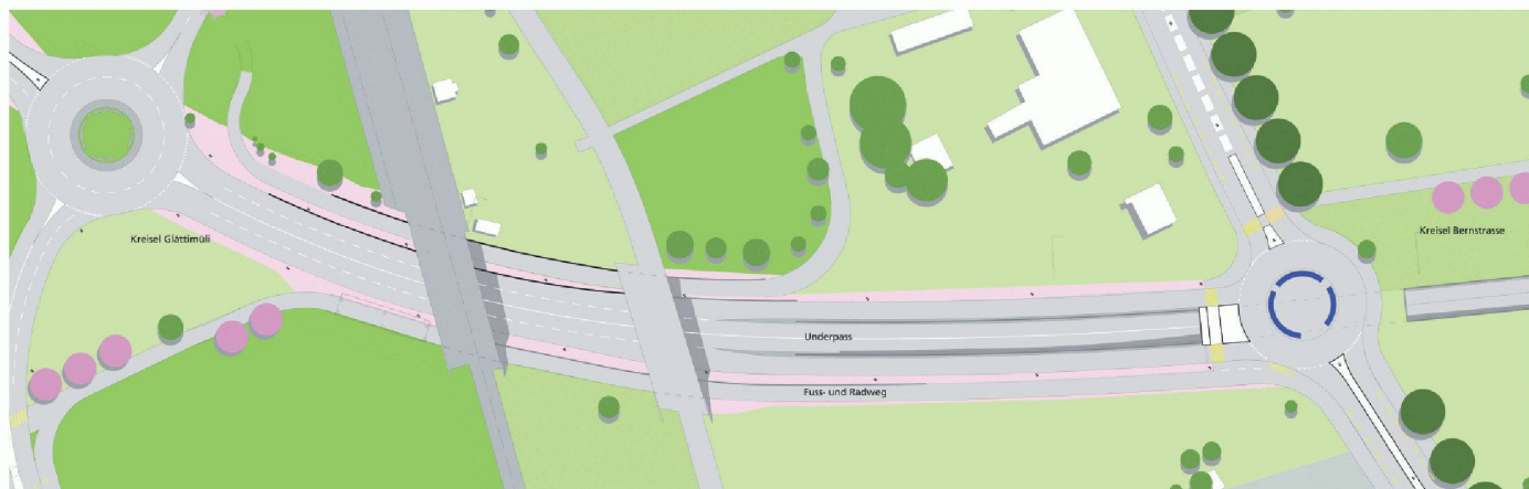
Der doppelspurige Kreis Glättimüli und der Kreis Bernstrasse sollen auf allen Zufahrten einen reibungslosen Verkehrsablauf sicherstellen (Weiterbearbeitung Verkehr, Team «liaison»)
