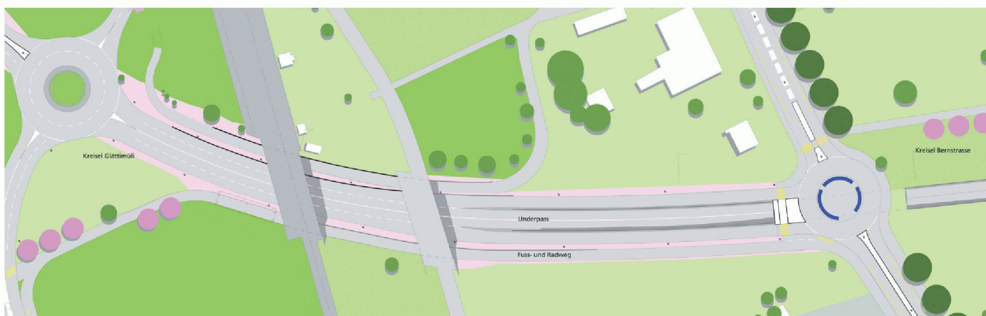
Der doppelspurige Kreisel Glättimüli und der Kreisel Bernstrasse sollen auf allen Zufahrten einen reibungslosen Verkehrsablauf sicherstellen (Weiterbearbeitung Verkehr, Team «liaison»)
