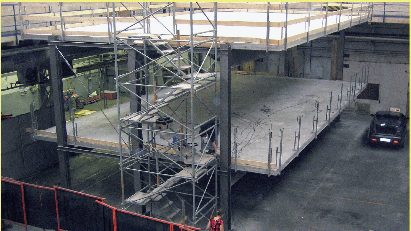
10 Versuchsstand mit zwei übereinander liegenden Verbundträgerdecken (Spannweite 15 m, Trägerabstand 3 m)
