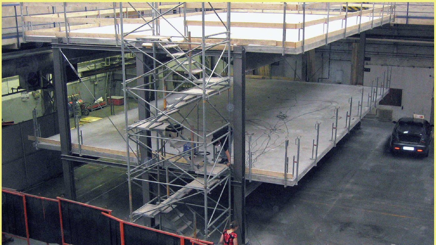
10 Versuchsstand mit zwei übereinander liegenden Verbundträgerdecken (Spannweite 15 m, Trägerabstand 3 m)
