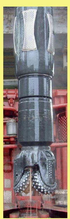
03 Dreirollenmeissel mit Hartmetallstiften (Warzenmeissel) vor dem Einfahren ins Bohrloch. Aus den Spüldüsen tritt Spülung aus. Oberhalb des Meissels ist im Bohrgestänge ein Stabilisator (mit Hartmetallplattierung) angeordnet (Bilder: Andreas Macek)
