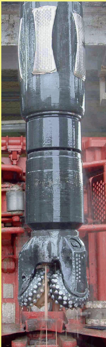
03 Dreirollenmeissel mit Hartmetallstiften (Warzenmeissel) vor dem Einfahren ins Bohrloch. Aus den Spüldüsen tritt Spülung aus. Oberhalb des Meissels ist im Bohrgestänge ein Stabilisator (mit Hartmetallplattierung) angeordnet (Bilder: Andreas Macek)
