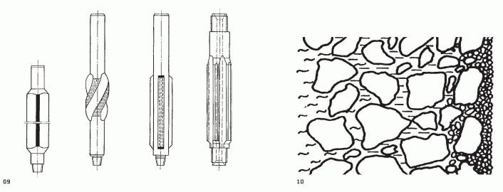
**09** Verschiedene Bauarten von Stabilisatoren, die ins Bohrgestänge eingebaut werden
