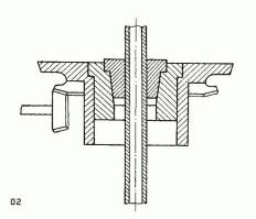
01 Schematische Darstellung einer Rotary-Tiefbohranlage mit Dieselantrieb (Bilder: Roland Wyss) 02 Schema eines Drehtischs (Querschnitt). Die sechseckige Mitnehmerstange (Kelly) in der Mitte bewegt sich mit dem Bohrgestänge in vertikaler Richtung
