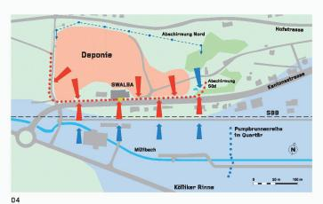
den über den gesamten Deponiekörper verteilt Rammsonden installiert. Die gesammelten Gase werden seitdem in zwei Hochtemperaturöfen bei 900°C verbrannt.
