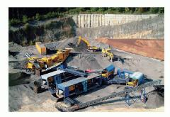
Backenbrecher aus dem Bergbau zertrümmern die mineralischen Schlackebrocken. Die weniger als 2 mm grossen Krümel werden abgesiebt, zurück bleiben die grösseren, lediglich verformten Metallstücke (Bild: Bau- und Umweltschutzdirektion Basel-Landschaft)
