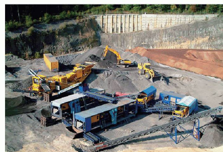
Backenbrecher aus dem Bergbau zertrümmern die mineralischen Schlackebrocken. Die weniger als 2 mm grossen Krümel werden abgesiebt, zurück bleiben die grösseren, lediglich verformten Metallstücke (Bild: Bau- und Umweltschutzdirektion Basel-Landschaft)
