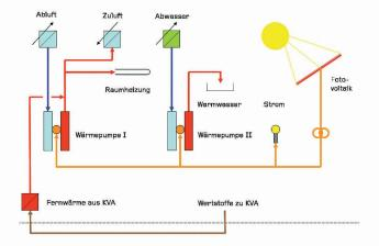
05 Beim Energiekonzept steht die Nutzung erneuerbarer Energiequellen im Vordergrund, ergänzt durch Wärmerückgewinnung (Bild: Allreal)
