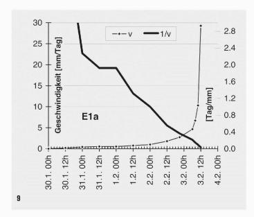
9 In der Darstellung der reziproken Verschiebungsgeschwindigkeit 1/v konnte das Absturzdatum des Felssturzes im Voraus erkannt und das einmalige Naturereignis vor Ort verfolgt werden
