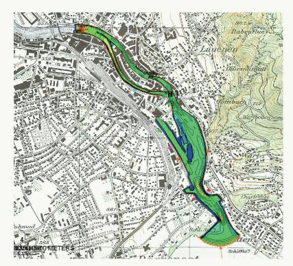
Hydraulische Berechnungen mit 2-D-Modell: Innere (rechts) und Äussere Aare sowie Schifffahrtskanal (Mitte links) mit anschliessendem Entlastungsstollen (Bild: bhc/aquavision)
