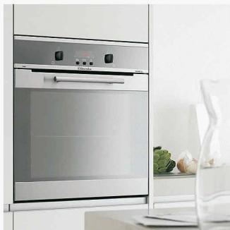
Auf der Messe stellt die Elektrolux AG einige Neuheiten vor. Der neue Backofen EB GL 80 kann sich selbst pyrolytisch reinigen. Wenn bei geschlossener Backofentür die Pyrolyse-Funktion aktiviert wird, werden sämtliche Rückstände bei einer extrem hohen Temperatur von knapp 500 °C zu Asche verschwelt und können anschliessend mühelos herausgewischt werden.
