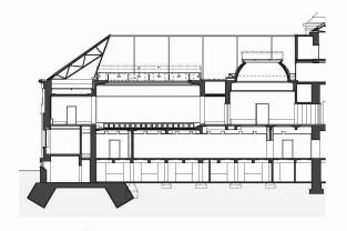
Längsschnitt durch den Moser-Bau 1 mit grossem Treppenhaus und den rückwärtigen Moser-Bau 3. Die verhältnismässig niedrige Raumhöhe des Kellergeschosses stellte für die Planung der Haustechnikzentralen eine Herausforderung dar. Mst. 1:750
