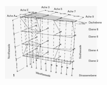
Schematische Darstellung des Haupttragwerks (Bild: Dr. Lüchinger + Meyer Bauingenieure AG)
