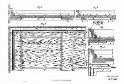
Zeichnung aus dem ersten Patent von Hetzer aus dem Jahre 1892. Es beschreibt die Konstruktion eines unterlüfteten Dielenfussbodens, welcher hei Bedarf im Falle von Schwinden in den vorhandenen Richtleisten nachträglich zusammengeschoben werden konnte (Bild: Otto Hetzer AG, Weimar)
