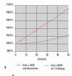
Anwachsen des Weltenergiebedarfs als Folge der Bautätigkeit in China ohne weitere Massnahmen sowie falls der Baubestand der gesamten OECD jährlich um 1 % durch Minergie (100 MJ/m²a) ersetzt würde (Bild: Autor)
