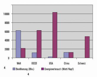
Vergleich der Bevölkerungszahl und des Leistungsbedarfs pro Kopf. Die «Säulenhöhe» für die Bevölkerung der Schweiz entspricht etwa der Strichdicke (Bild: Autor)
