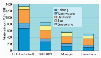
Energiebedarf bei verschiedenen Baustandards: Bei der Heizenergie fallen Ersparnisse am meisten, bei der Warmwasserbereitung in zweiter Linie ins Gewicht. Beim Warmwasser kann Sonnenenergie einen namhaften Beitrag leisten. Bei ausgeschöpften Sparmöglichkeiten nimmt der Anteil an Grauer Energie prozentual zu (Grafik: Schweizer Energiefachbuch 2003)
