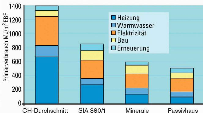
**Energiebedarf bei verschiedenen Baustandarden:** Bei der Heizenergie fallen Einsparisse am meisten, bei der Warmwasserbereitung in zweiter Linie ins Gewicht. Beim Warmwasser kann Sonnenenergie einen namhaften Beitrag leisten. Bei ausgeschöpften Sparmöglichkeiten nimmt der Anteil an Grauer Energie proportional zu (Grafik: Schweizer Energiefachbuch 2003)
