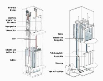
Links Seilaufzug, rechts hydraulischer Aufzug (Bilder: Schindler)
