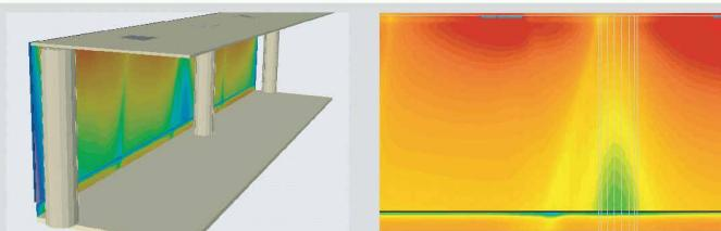
Im Beispiel links wurde die Raumluftströmung so optimiert, dass auf der Fassade garantiert zu keinem Zeitpunkt Kondensation auftritt. Die Berechnung der Luftströmung und der Temperaturen erfolgte mit einer CFD-Simulation.
