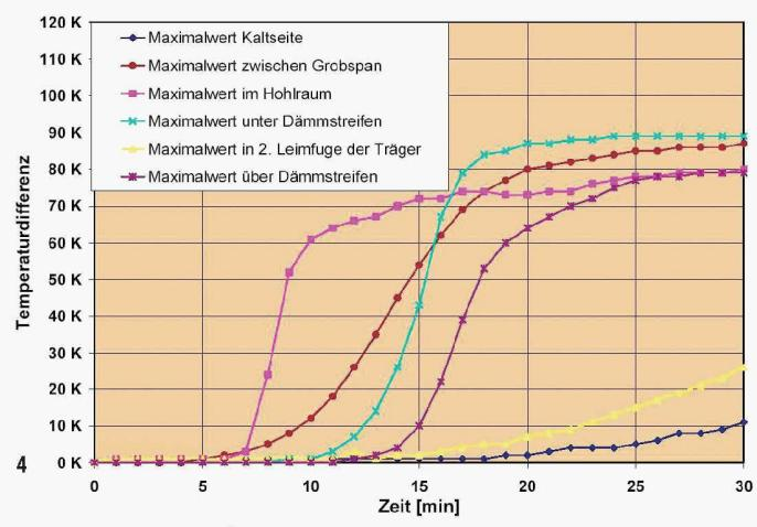
4 Temperaturkurven der Brandversuche. Eine spezielle Imprägnierung verringert den Abbrand. Auf der Kaltseite nahm die Temperatur lediglich um 11°K zu (Bild: Empa)
