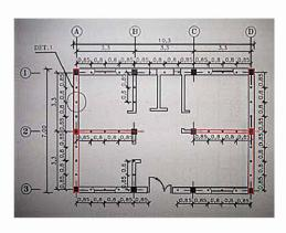
Plan mit der Anordnung der Wandscheiben (Stabilisierungswände ohne Öffnungen rot), die das Haus in alle Richtungen und gegen Verdrehen stabilisieren
