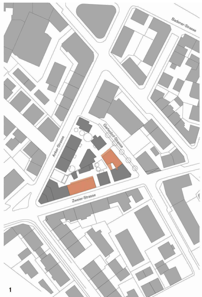
Situationsplan Dreieck in Zürich. Altbestand dunkelgrau; Neubauten braun, überdeckte Aussenräume aufgehellt; Umgebung hellgrau; Mst. 1:2000 (Plan: StadtWerke)
