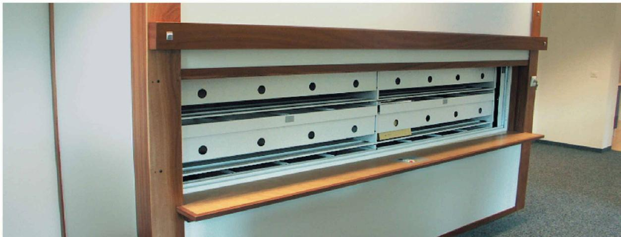
Der Platzbedarf für die effiziente Bearbeitung von ca. 43 Laufmetern Hängemappen beträgt bei einer Raumhöhe von 2.6 m rund 3.84 m<sup>2</sup>. Die Entnahme der Hängemappen erfolgt auf angenehmer Arbeitshöhe. Der Zugriff auf das gesuchte Dossier ist einfach und schnell. Die feuersichere Verkleidung Fermacell® wird den Dimensionen des Raumes angepasst.
