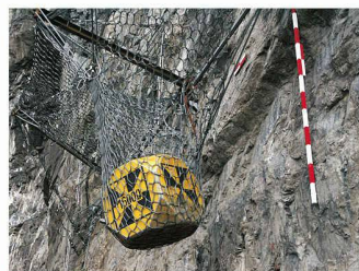
Test bestanden – der Prüfkörper hängt im Netz (Bild: Autor). Rechts: Bremsringe ziehen sich bei grosser Krafteinwirkung zusammen (Bild: Geobrugg)
