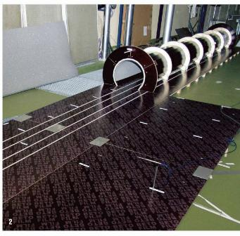
2 Massstabsmodell 1:16 zur Untersuchung der Schallausbreitung an Eisenbahntunnelportalen
