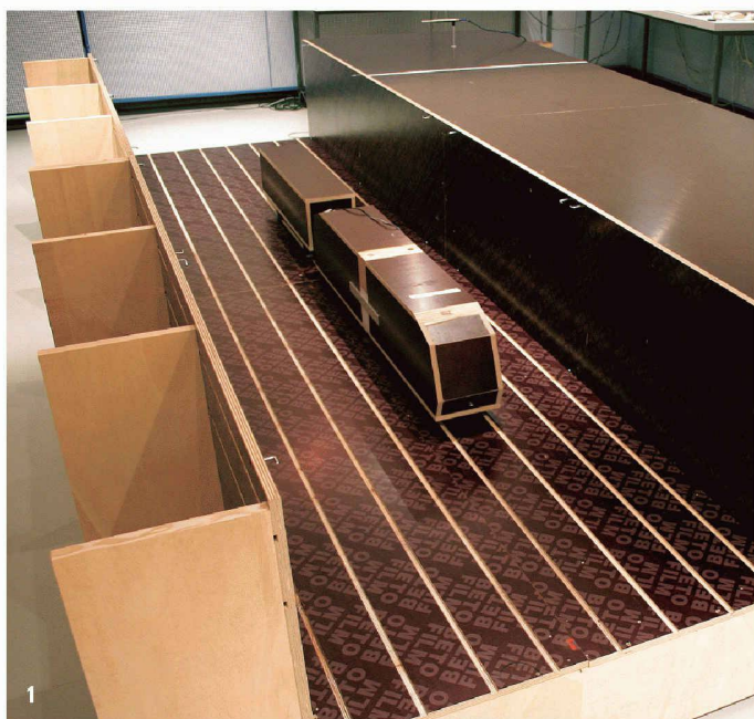
1 Masstabmodell 1:16 zur Untersuchung der Schallausbreitung in Eisenbahneinschnitten (Bilder: Empa)
