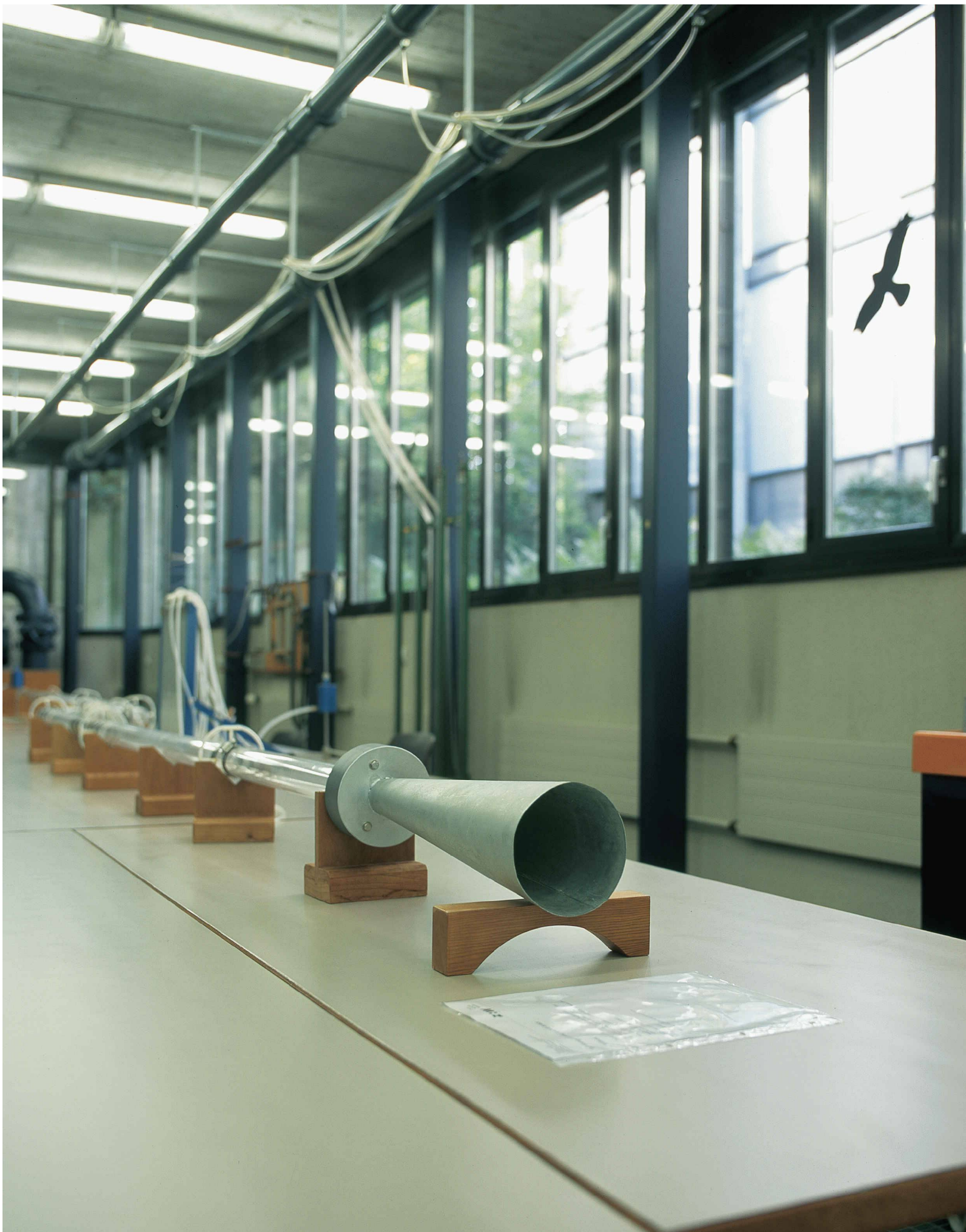
7 Luftströmungsmodell im Wasserbaulabor (Bild: Christian Schwager)
