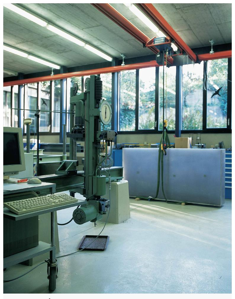
2 Werkstatt und Prüfmaschinen: Biegemaschine mit 100 kN Maximallast für elektronische Kraftaufzeichnung
