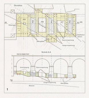
Grundriss und Ansicht des Unterfangungssystems für die Pfeiler 16, 17 und 18 des Grand-Pont (Plan: Piguet+Associés)
