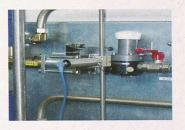
und Abfüllanlagen. Gemessen wird berührungslos mittels Ultraschall durch die Rohrwand hindurch, so dass keine baulichen Veränderungen am Rohr notwendig sind, unabhängig davon, ob die Rohrleitung aus metallischen Werkstoffen, Kunststoffen oder aus Glas besteht. Je höher die Druckstufe oder die Reinheitsanforderungen, desto mehr kann der Sonocontrol 15 seine spezifischen Vorteile einbringen.
