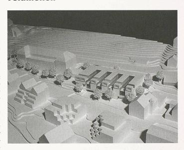
Fingerförmige Baukörper orientieren sich zum See, der rückwärtige Riegel schützt vor Bahnlärm (1. Rang, ADP Architekten)
