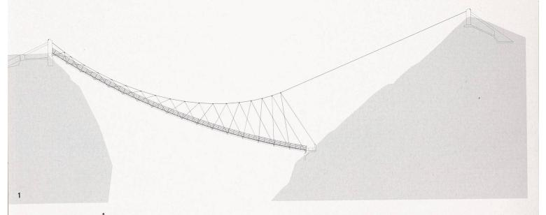
Ansicht. Durch die Vorspannung der Tragseile wird das Gesamtsystem ausgesteift. Der Brückensteg selber ist eine Holzkonstruktion. Das südliche Brückenauflager (unten rechts) wird – infolge der Seilaufhängung – nur gering belastet. Es konnte entsprechend klein dimensioniert werden. Mst. 1:600 (Plan: Ingenieure)
