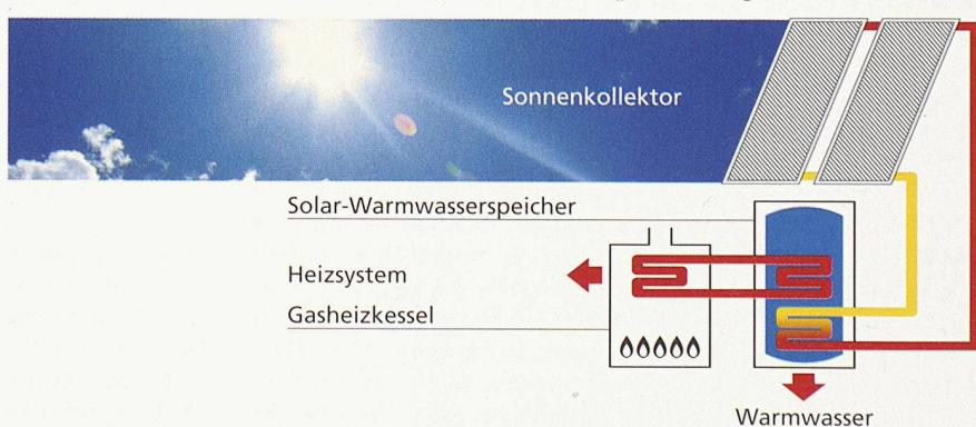
Heizungsanlage vor. Der Restbedarf wird zuverlässig von der Erdgas-Heizung gedeckt. Mit dieser Kombination beträgt der Anteil der solaren Gratisenergie am Gesamtenergiebedarf 25 bis 30 %.
