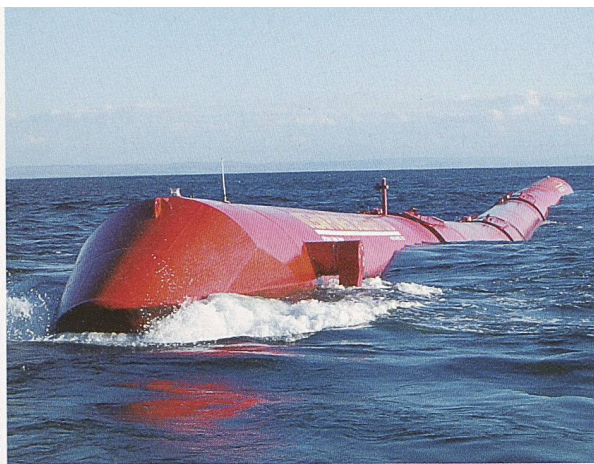
Drei solche Pelamis-Wellenenergiekonverter sollen noch dieses Jahr vor der Küste Portugals Strom erzeugen (Bilder: OPD)
