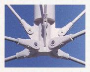
jedoch die Sicherheit. Zusätzlich zu den zahlreichen Prüfvorgängen besitzen sämtliche Systemteile Sicherheitsreserven, die weit über die geforderten Werte der Zulassung hinausgehen. Für die Stabanker wird Gusseisen mit Kugelgrafit mit garantierter Kerbschlagarbeit bei –20°C eingesetzt. Gegenüber dem rissanfälligen Stahlguss bietet es sicherheitsrelevante Vorteile. Dieser Gusswerkstoff wird u.a. in den Hochalpen für Sicherheitsteile bei Seilbahnen und Skiliften eingesetzt.
