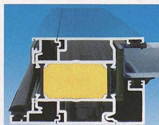
mit schmalen Ansichtsbreiten vor, die eine hohe Wärmedämmung und eine einfallsreiche Technik aufweist. Im Innern der Solarlux-Faltwand ist ein 24 mm starker Schaumkern verantwortlich für die bei dieser geringen Profildicke aussergewöhnlich hohe Wärmedämmung.
