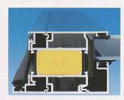
mit schmalen Ansichtsbreiten vor, die eine hohe Wärmedämmung und eine einfallsreiche Technik aufweist. Im Innern der Solarlux-Faltwand ist ein 24 mm starker Schaumkern verantwortlich für die bei dieser geringen Profildicke aussergewöhnlich hohe Wärmedämmung.
