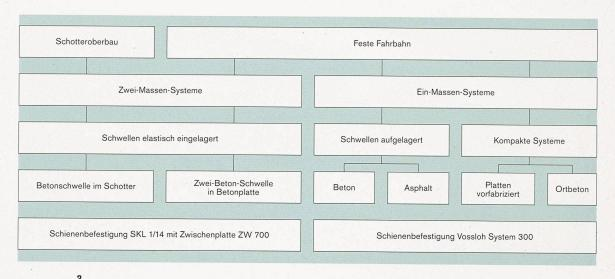
Systemübersicht der Eisenbahn-Fahrbahnen (Bild: Rolf Steinegger/SBB)
