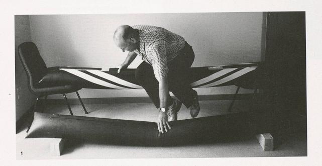
Das Prinzip Tensairity: Eine unter leichtem Innendruck stehende Membran eliminiert Stabilitätsprobleme wie das Knicken des Druckgurtes. Die dadurch erreichte volle Ausnützung der Materialfestigkeiten ermöglicht die Konstruktion sehr leichter und effizienter Tragwerke.
