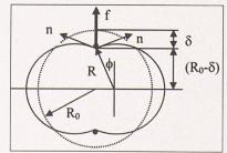
externen Belastung  $q=1~kN/m^2$  beträgt der im Schlauch notwendige Druck bloss  $p=5~kN/m^2$ , d. h. 50~mbar!
