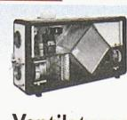
**Ventilatoren mit Wärmerückgewinnung** für Bad/WC, Küche, Wohnraum. Automatische Sommer-/Winter-Umstellung. Mit 24 V DC-Motoren. 400 m³/h.
