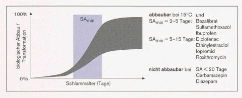
Grafik 3 Der biologische Abbau bzw. die Transformation von Spurenstoffen (grauer Bereich) ist abhängig vom Schlammalter (SA) des Belebtschlamms<sup>3</sup>
