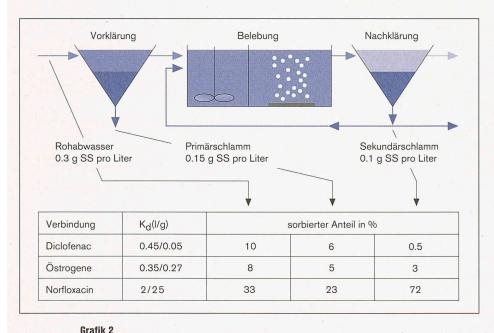
Sorptionskonstante und sorbierter Anteil ausgewählter Verbindungen an die suspendierten Stoffe (SS) im Zulauf sowie im Primär- und Sekundärschlamm.<sup>3,4</sup> In der Spalte K<sub>d</sub> gilt der erste Wert für Primärschlamm, der zweite Wert für Sekundärschlamm
