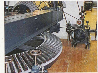
Ehemaliges Reusskraftwerk bei Bremgarten: Oeler (oben) und Teilansicht des Antriebs mittels Holzzahnrad (Bilder: Josef Schwitter)
