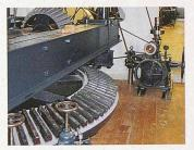
Ehemaliges Reusskraftwerk bei Bremgarten: Oeler (oben) und Teilansicht des Antriebs mittels Holzzahnrad (Bilder: Josef Schwitter)
