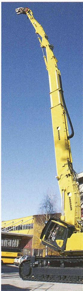
Ein solider Schutzvorhang sorgt für Sicherheit und wirksamen Schutz der Umgebung. Dahinter sind unsere Spezialgeräte im Einsatz. Sie beissen sich durch Stahlträger, Beton und Armierungen jeder Stärke und Dimension, als wärs Butter. Und sie portionieren das Ausbruchmaterial schon am Objekt.
