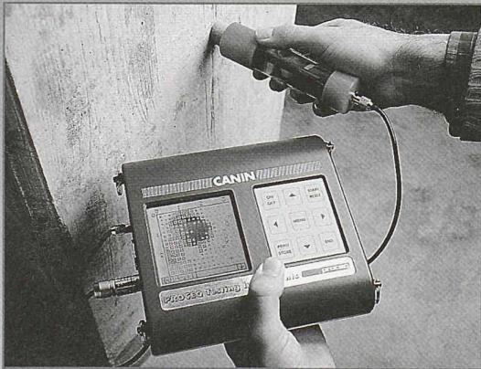
CANIN von Proceq ermittelt zeitsparend die Korrosionspotentiale der Bewehrung. Die Potentialmessung wird zur Zustandsanalyse an Betonbauwerken eingesetzt.
