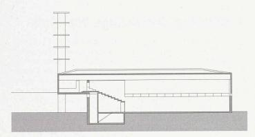
Auf dem Schnitt ist das über dem Feuerwehrareal auskragende Foyer erkennbar (1. Rang, GXM Architekten)
