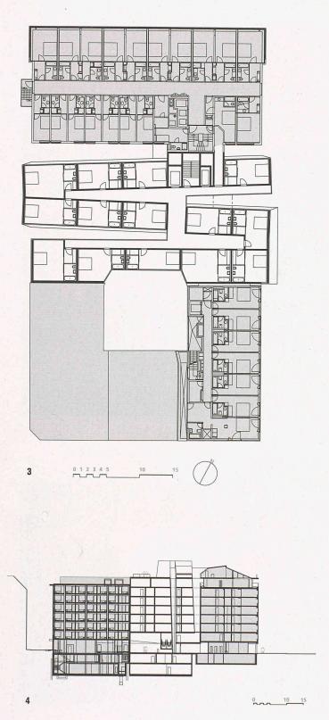
3+4 Grundriss 3.-6. Obergeschoss, Mst. 1: 500, sowie Querschnitt, Mst. 1: 1000
