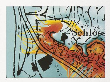
Geodaten wie Höhenmodelle, Bodenbedeckung und Verkehrsachsen als Grundlage für die Darstellung einer Steinschlagsituation (Bild: Jordan/Böhringer AG)
