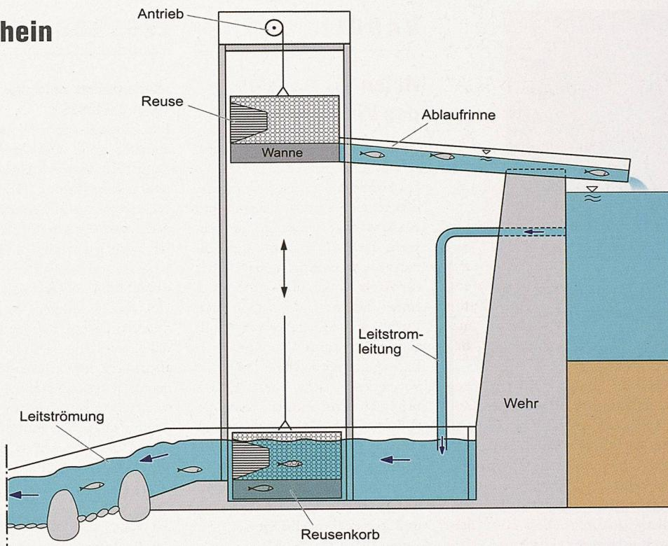
**Fischlift.** Technische Daten: Höhenunterschied Unterwasser-Oberwasser: 5.5–6.5 m; Höhe Aufzugsturm: 16.75 m; max. Betriebsabfluss: 1200 l/s; Abmessungen Reusenkorb: b 2.5 m, l 2.5 m, h 1.5 m; Volumen der Wanne: 2150 l; Leitströmung am Einlasstrichter der Reuse: 1 m/s; Betriebsintervall: 1–3 h (Bild: Energiedienst AG)
