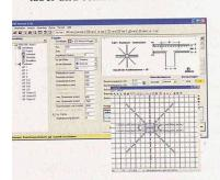
Durchstanzelemente ermittelt und zusätzlich als Verlegeplan und Stückliste ausgedruckt werden. Wer mit CAD-Software arbeitet, hat die Möglichkeit, den Verlegeplan als DXF-File zu exportieren und die HDB-Elemente und Riss-Dübelleisten exakt in den Bewehrungsplan zu platzieren. Aussparungen in Stützennähe werden dabei ebenso berücksichtigt wie Randstützen, Eckstützen, Wand-Innenecken und Wandenden.
