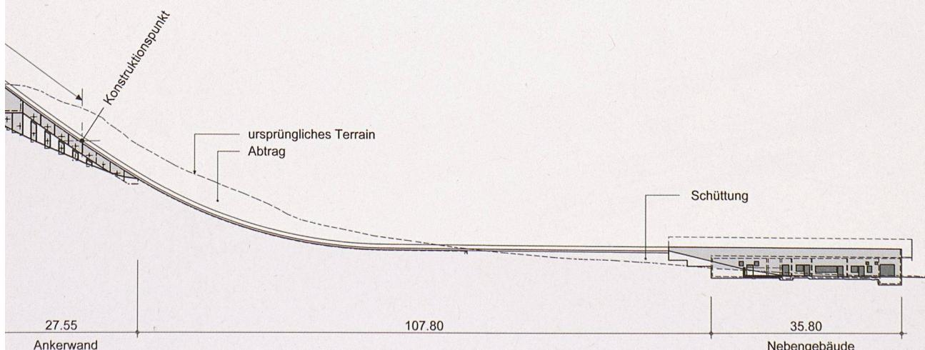
führt worden. Während der Schüttarbeiten sind im unteren, flachen Bereich Kriechbewegungen aufgetreten. Die Schüttarbeiten mussten deshalb verlangsamt werden, damit sich der zusätzliche Porenwasserdruck abbauen konnte.
